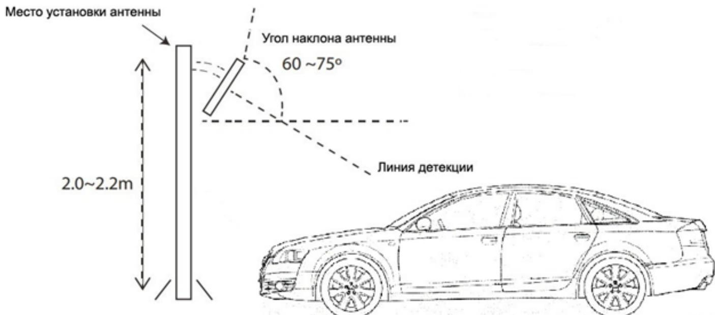
Область стабильного считывания UHF-меток считывателем представляет собой конус, угол вершины которого равен  $\approx 35-40^\circ$
