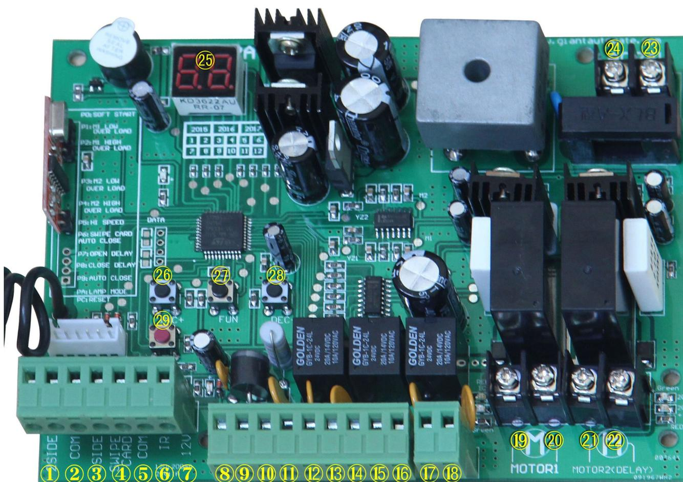
Рис. 9. Плата управления приводом
