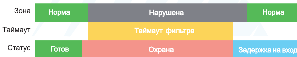
Рисунок 6. Начало задержки на вход по окончании таймаута после нарушения зоны Вход-выход.
