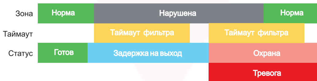
Рисунок 7. Нарушение зоны в момент постановки на охрану.
