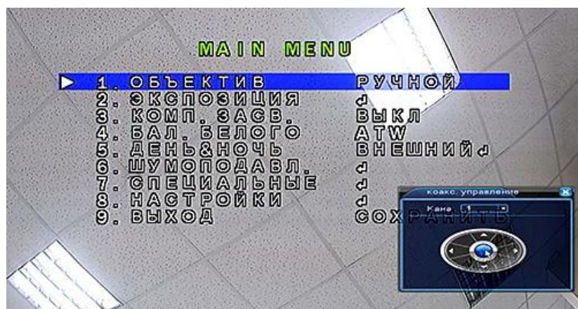
**Внимание:** Управление по коаксиальному кабелю является дополнительной функцией видеорегистратора. Успешная работа данной функции зависит от конкретной модели видеорегистратора и видеокамеры, длины и параметров коаксиального кабеля, а также отсутствия сильных электромагнитных помех. При использовании устройств передачи видеосигнала по витой паре управление настройками видеокамеры по UTC протоколу не гарантируется.
