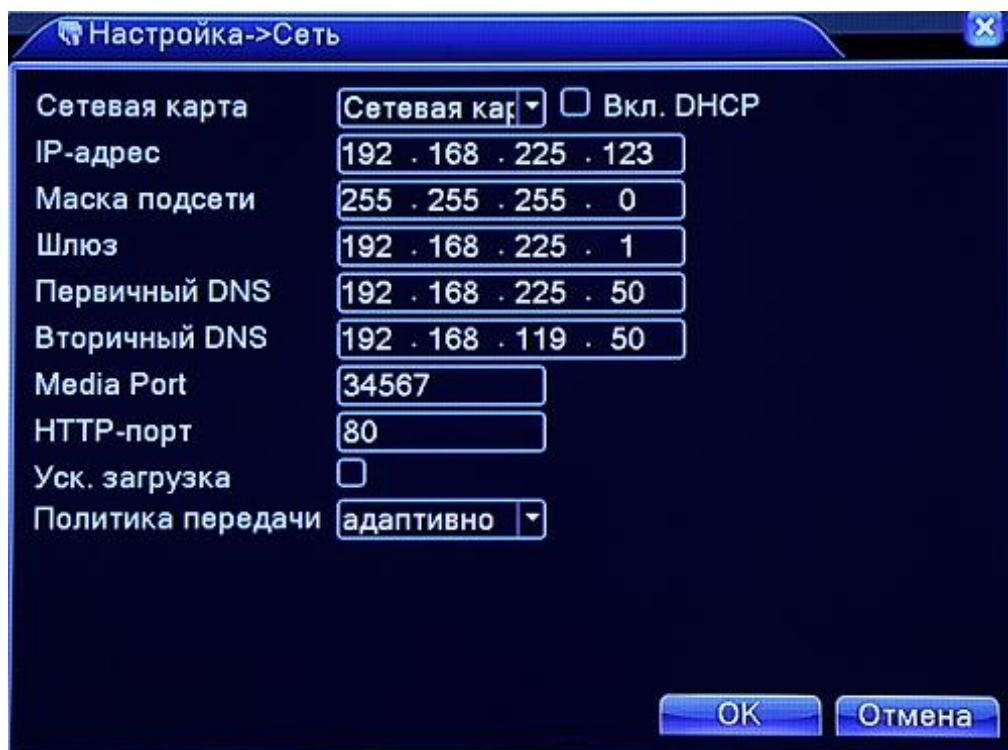
Рис. 4.22 Сетевое соединение
