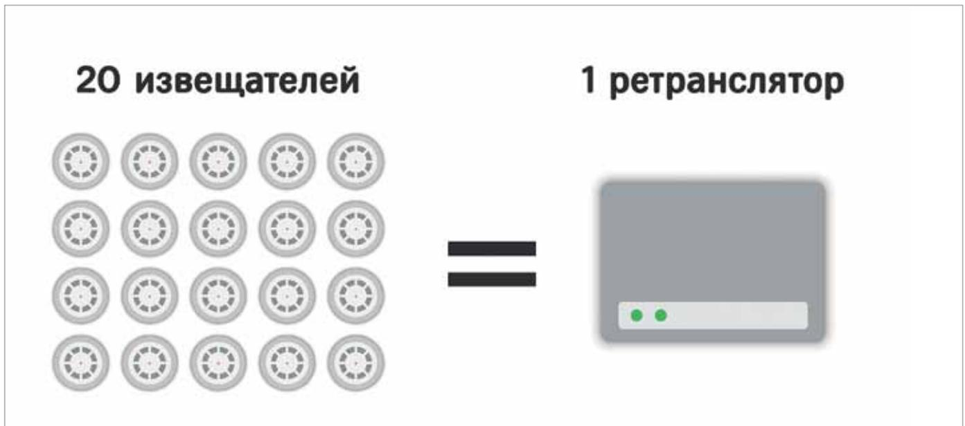
Рис. 2. Примерное соотношение количества извещателей на 1 ретранслятор
