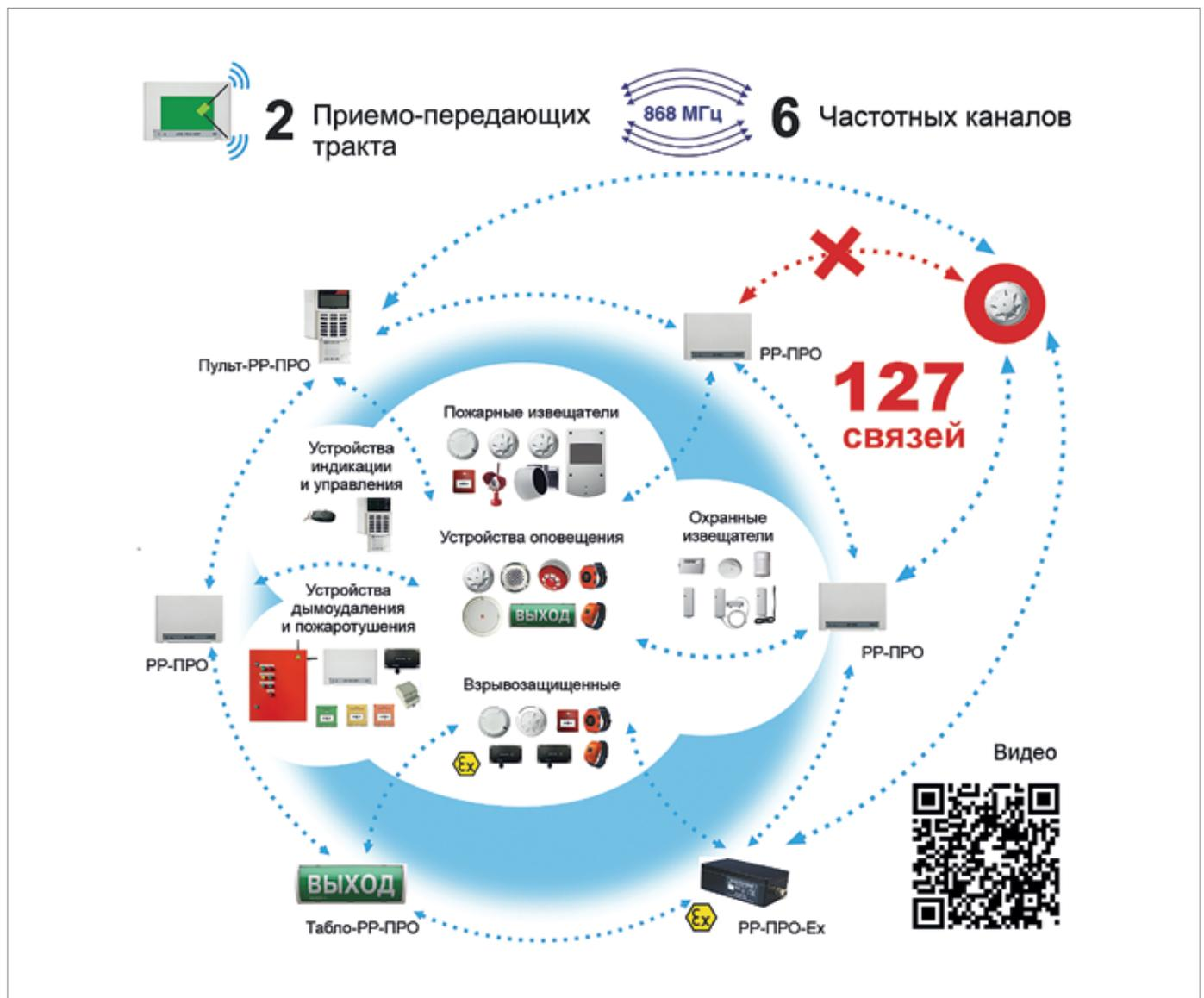
Рис. 1. «Стрелец-ПРО» соответствует требованию о единичной неисправности
